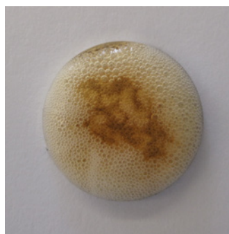
3. Reacción positiva al aplicar BioFinder sobre una superficie contaminada con biofilms
